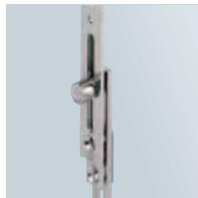
Hier ist der Teil des Mechanismus im Anschlag des Fensters versteckt und ist kettenmäßig verbunden (Schließstifte sind auf allen vier Fensterseiten im Rahmen verankert). Mit Hilfe der Fensterklinge können wir die Abspernungen einfach zwischen den Stiften bewegen und so die gewünschte Position des Fensters ermöglichen (verschlossen, drehbar oder kipp geöffnet). Die Stifte können wir manuell einstellen und so die Fensterdichtung regulieren.
